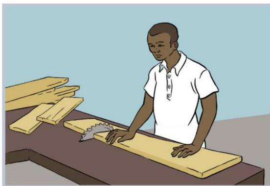
通过调查发现本次事故的直接原因是操作员手碰到锯片；间接原因是锯片没有安装防护装置以及操作员在危险状况下使用圆锯。但是，监察员需要进一步查明事故的根本原因，例如：锯片为什么没有安装防护
